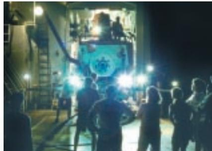
■「愛文號」潛艇測試照明燈，每個燈泡為1200瓦，在岸上測試時必須噴水降溫。
