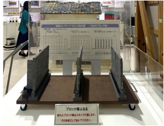
圖 70，不同圍牆結構的耐震能力，日本民宅的圍牆有潛在風險
