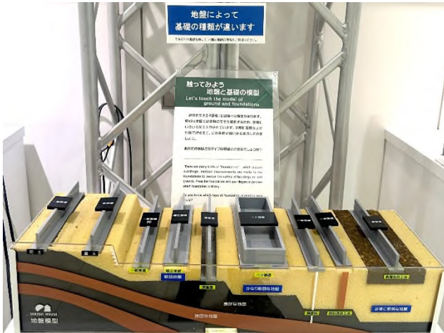
圖 71，不同基礎結構的模型
