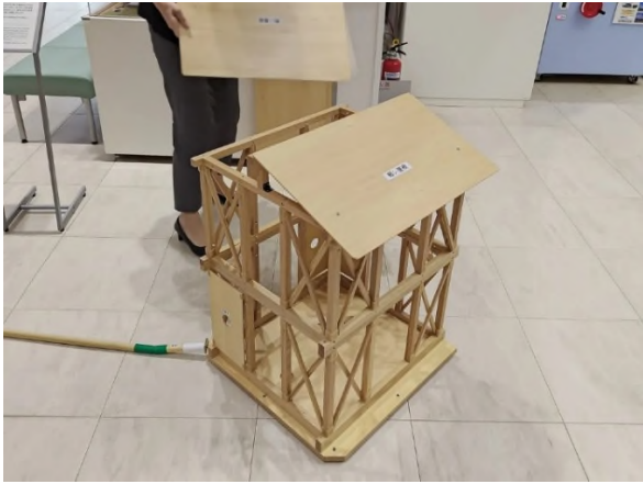
圖 69，展示建築支撐結構的模型，該教具可以拆卸，用以說明柱間支撐結構和牆板的作用
