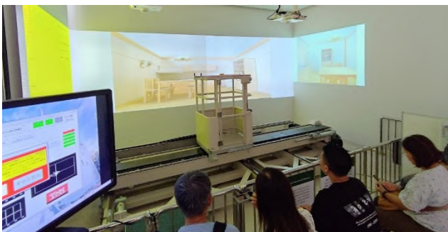
圖 67，BiCURI 地震再現裝置，工作臺的護欄內可容納 1 人，主要以投影機搭配機械模擬在不同地震波形的影響下，室內家具與窗外的建築群會有什麼可能的災情
