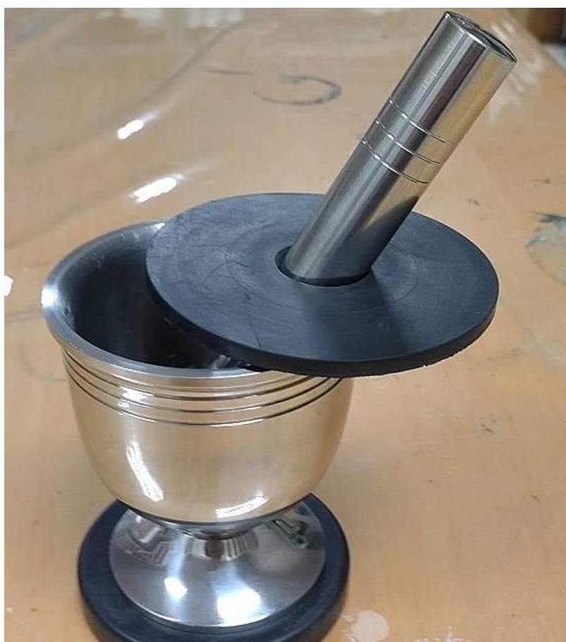
圖 10. 用鐵鉢來敲碎金伯利岩，礦物分離淘選後，小小的鑽石會就出現了。
