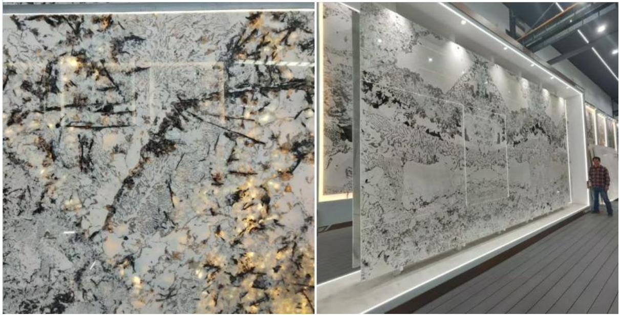
圖 23. 在部分石板可清楚看到岩漿結晶時熔岩與早期接晶礦物相互作用關係，文象結構(graphic texture)與蠕蟲結構(myrmekitic texture)。
