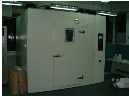
圖 15. 用恆溫恆溼機將溫度調至 65°C、溼度調至 85%，連續調溼 2 個月。（攝影／王督宜）
