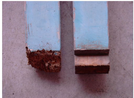
圖 26. 橫撐杠榫卯損壞情形 (攝影/王督宜)
