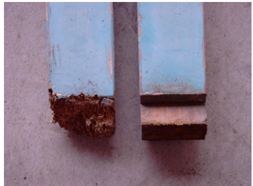
圖 13. 刀劍屏斜撐杠樺卯損壞（攝影／王督宜）
