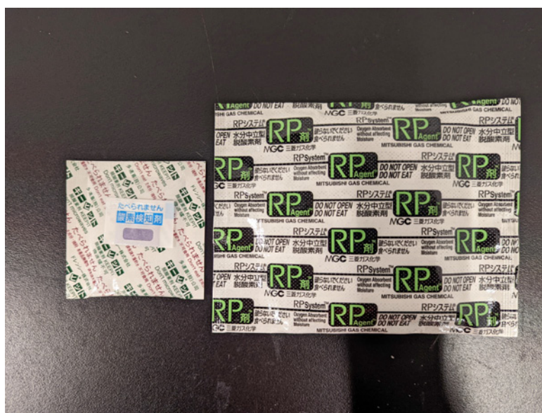
圖 6. 左：多連喜 PQ-300PW 含粉狀氧氣檢知劑之鐵系脫氧劑，尺寸為 60 x 60mm；右：三菱氣體化學 RP-20K 有機型脫氧劑，尺寸為 100 x 130mm。（攝影／呂釗君）
