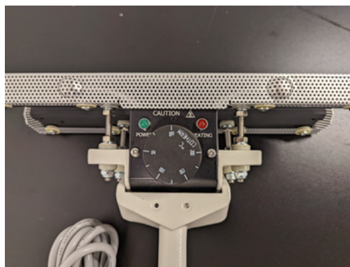
圖 5. 熱封夾溫度控制轉盤與指示燈號（攝影／呂鈞君）
