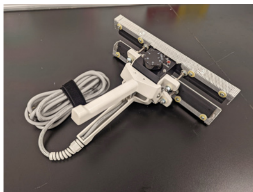
圖 4. 長 30cm，封口寬度 1cm 的熱封夾。（攝影／呂鈞君）
