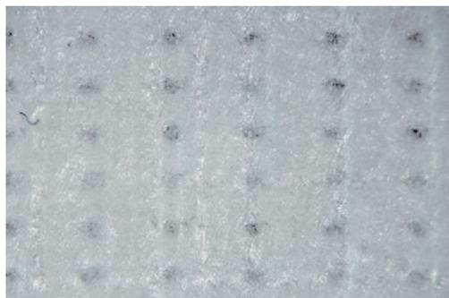
圖 4. 類布型泰維克<sup>®</sup> 放大 20 倍，左圖：印痕面，右圖：光滑面。（攝影／呂鈞君）
