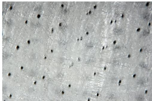
圖 6. 微穿孔型泰維克®放大 20 倍，左圖：印痕面，右圖：光滑面。（攝影／呂釗君）
