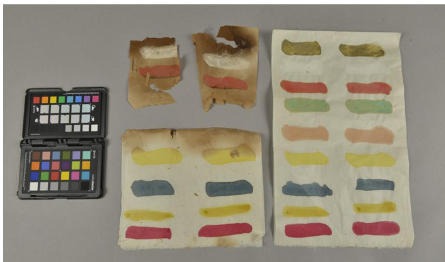
圖 1. 左：傳統國畫顏料及紙張以燻蒸劑 Ekibon<sup>®</sup> 處理的實驗組，部分顏料變色、紙張腐蝕、有脆裂現象；右：未經 Ekibon<sup>®</sup> 燻蒸之對照組。(攝影／陳澄波)
