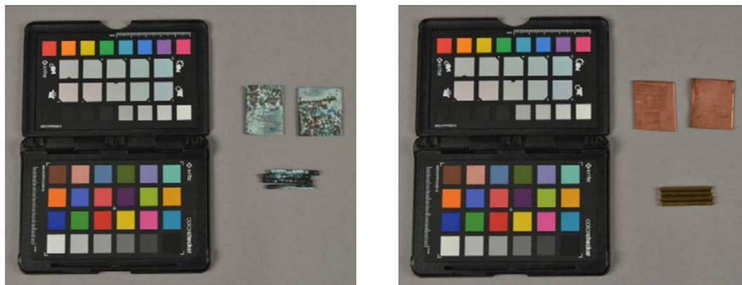
圖 5. 左圖：紅銅（上 2 方片形）及黃銅（下 4 圓條形）以燻蒸劑 Ekibon<sup>®</sup> 處理的實驗組受腐蝕產生藍白色粉末；右圖：未經 Ekibon<sup>®</sup> 燻蒸之紅銅（上 2 方片形）及黃銅（下 4 圓條形）對照組。（攝影／陳澄波）
