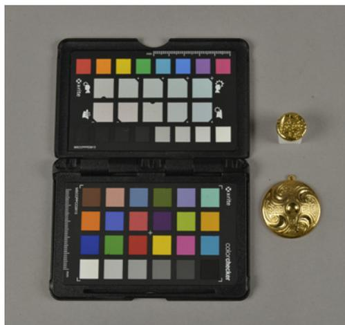
圖 2. 左：鍍金以燻蒸劑 Ekibon<sup>®</sup> 處理的實驗組，鍍金樣本光澤度降低；右：未經 Ekibon<sup>®</sup> 燻蒸之對照組。（攝影／陳澄波）
