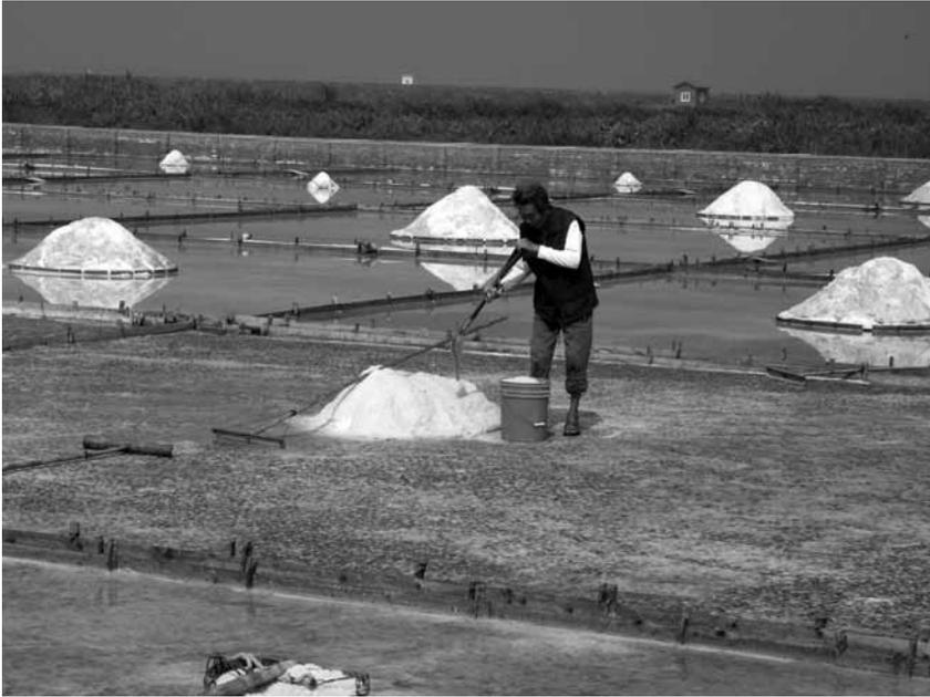
圖 5. 井仔腳鹽田中，被刻意堆成一堆堆的小鹽山，小鹽山的底部用紅磚塊墊高，防止鹽被鹹度較淡的滷水溶掉（攝影／楊凱成，2009）。
