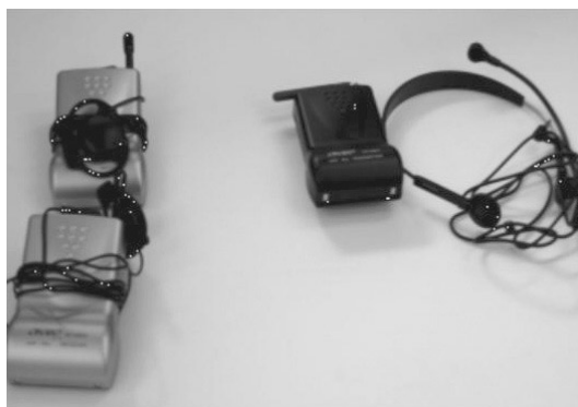
圖7. 較圖6輕巧，導覽器材包括(右)發射器、耳機、麥克風(左)接收器、耳機。(筆者攝於故宮)
