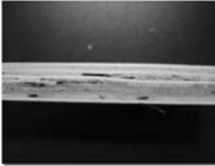
圖6. 大陸合板(D1)欠膠情況
