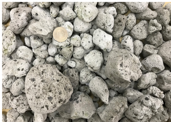
圖2 浮石由淡色玻璃物質及少量深色斑點聚集的細小晶體所組成
