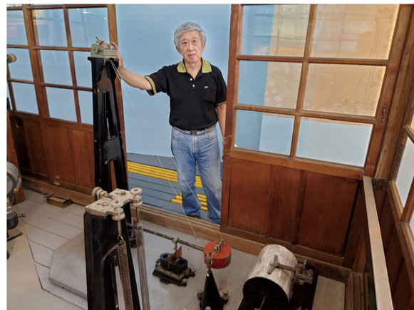
圖2 921地震教育園區展示的大森式水平地震儀(原設置於臺北測候所)，於2021年5月10日完成建置。人物為劉玉龍老師，為臺灣歷史地震儀專家。
