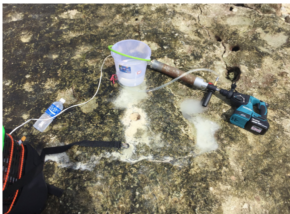
圖2 這次帶去的小型鑽岩機，先在岸邊的灘岩(beach rock)試用，證實可行。
