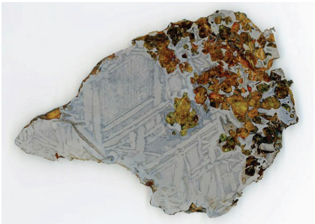
圖4 俄羅斯Seymchan 石鐵隕石，1967年被發現時被認為是鎳鐵隕石，但在2004年新找到的標本中約有兩成含有橄欖石，因此被重新歸類為橄欖隕鐵。此標本金屬區域可見鐵紋石以特定方向生長所造成的韋德曼交紋圖案。其橄欖石晶體外形相當不規則，以圓滑狀為主，局部呈多角狀。標本高14公分、寬10公分。
