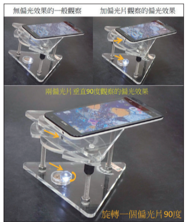
圖5 一般正立Scimage手機顯微鏡，橄欖石磨片的偏光觀察。
