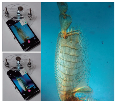
圖6 倒立顯微鏡偏光模組的用法-觀察蜜蜂的足部顯微構造
