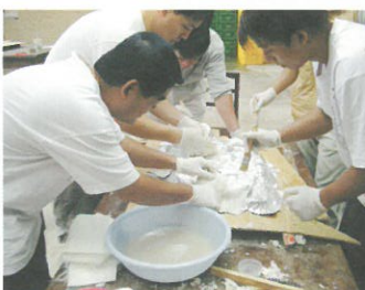
圖12、13.硬模製作（選擇FRP材質，共刷6層加3層）。
