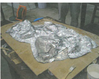
圖11.翻製脫模前的隔離措施（錫箔紙與凡士林）
