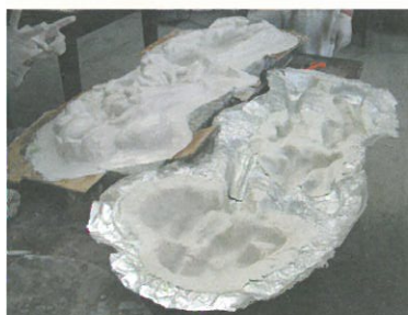
圖14.掀開硬模時必須由外向內，由低向高掀起。
