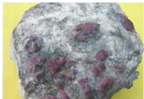
圖5.接觸變質帶大理岩(變質石灰岩)含紅寶石巨晶
