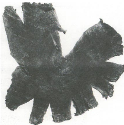
圖5. 飽水木質文物任其自然乾燥後之嚴重乾裂收縮情形(取材自Masaaki, 1997)
