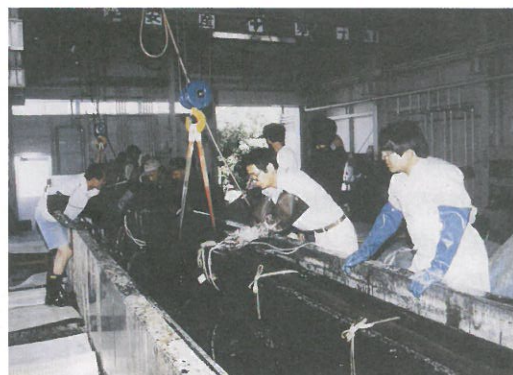
圖7. 大型PEG浸漬槽(取材自Masaaki, 1997)
