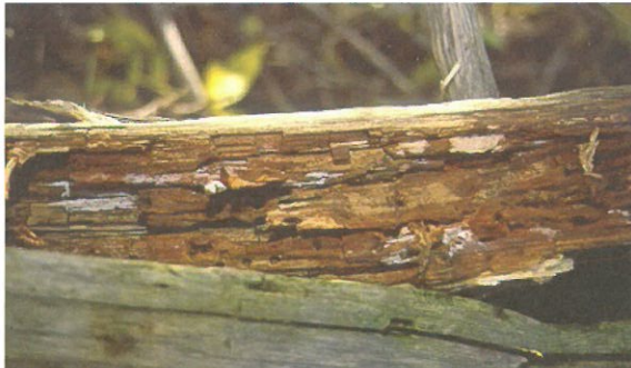
圖3. 褐腐菌分泌酵素分解木材中大部分之纖維素及半纖維素，而成褐色。
