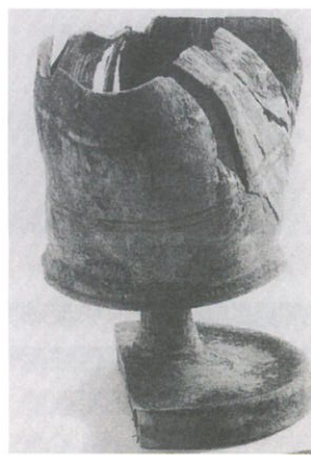
圖6. 收縮變形的木製高腳杯(取材自Masaaki, 1997)
