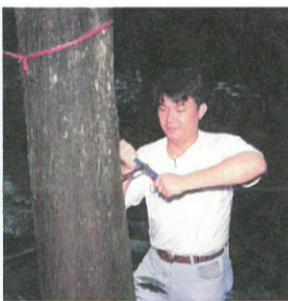
圖2. 以生長錐鑽取樣本需要由不同方位進行，鑽取後需塗以凡士林處理，以防菌類侵入。
