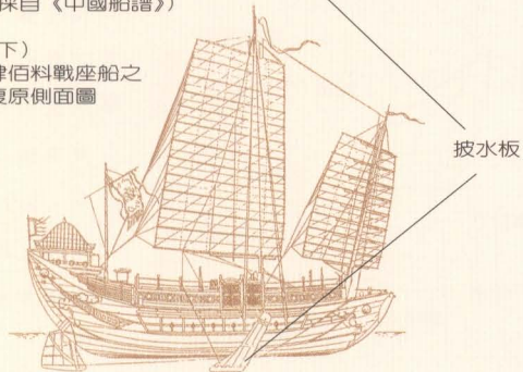
圖10. 沙船的披水板
