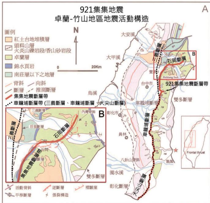
圖3 集集地震斷層(橘線)與車籠埔斷層(黑色虛線)位置示意圖，地震斷層在石岡附近走向轉為東北西南向。(修改自陳文山等人, 2000)
