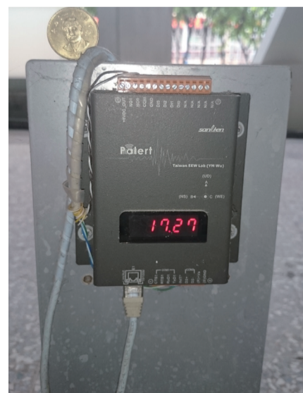
圖4 921地震教育園區現地地震預警系統的現地P波偵測器。本設備由三聯科技公司捐贈。
