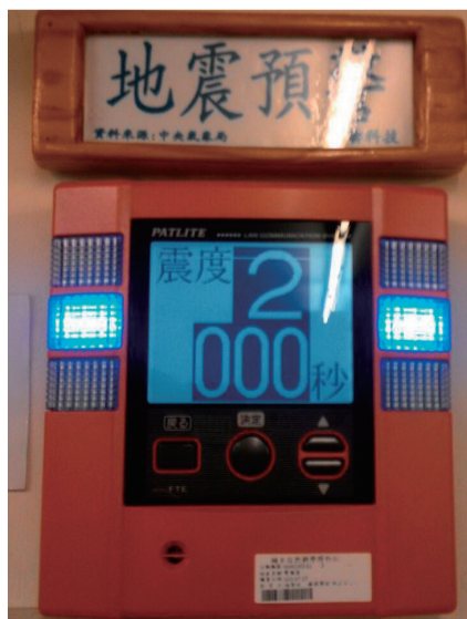
圖3 921地震教育園區現地地震預警系統警報器運作中的畫面。本設備由三聯科技公司捐贈(照片提供：許婉瑜)
