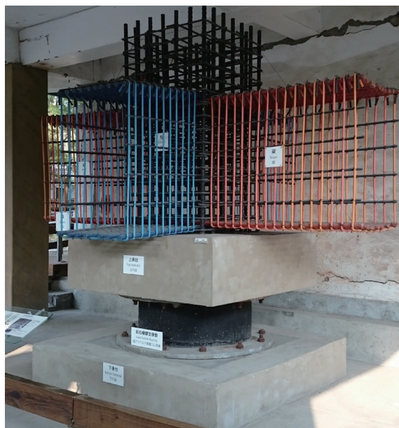
圖5 國內自製「積層鉛心橡膠支承(LRB)」隔震器實品（照片下方黑色部分：展示於921地震教育園區）
