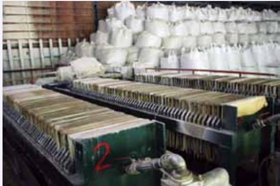
圖6. 浮選廠之脫水泥餅機，後方白色袋裝為絹雲母分級產品。
