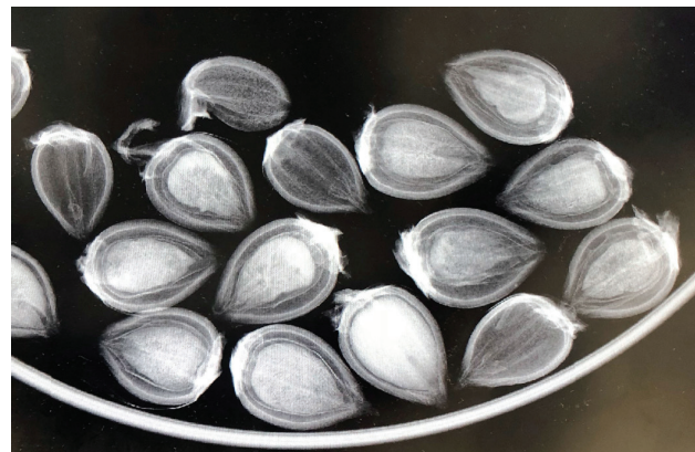
圖5 利用低功率X光檢測種子品質
