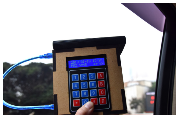
圖2 可攜式PM2.5空氣盒子即時檢測現地空氣品質
